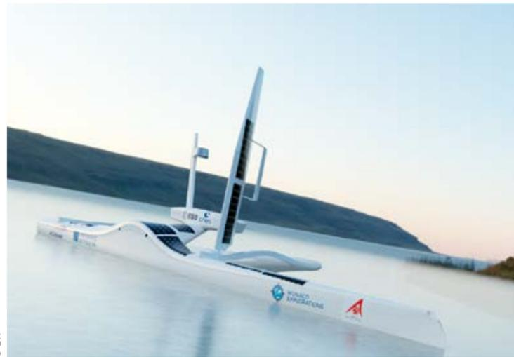
Le *Sphyrna 70*, 21 mètres de long, 4 mètres de large, vitesse de pointe 17 nœuds, autonomie 12 mois, plus d'une tonne de capacité d'emport, est propulsé par un moteur électrique alimenté par les énergies solaire, éolienne et hydrolienne.
